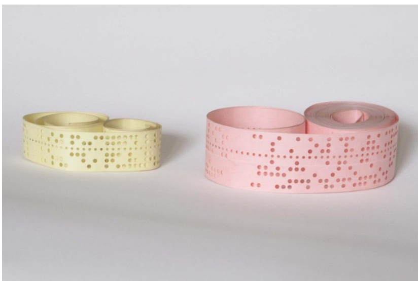
Obrázek 1 - Klasický vzhled děrné pásky.
